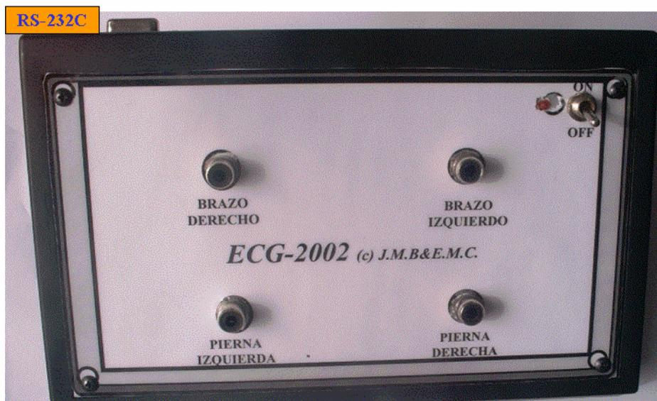
**Fotografía 3.-** Aspecto del ECG2002B. El frontal dispone de cuatro clavijas para la conexión de los electrodos y en la parte trasera, se encuentra el conector para el cable serie RS-232 que lo comunica con el ordenador personal. El filtro de red 50Hz, la ganancia y el ajuste de la línea base se realizan de forma automatizada desde el PC.
