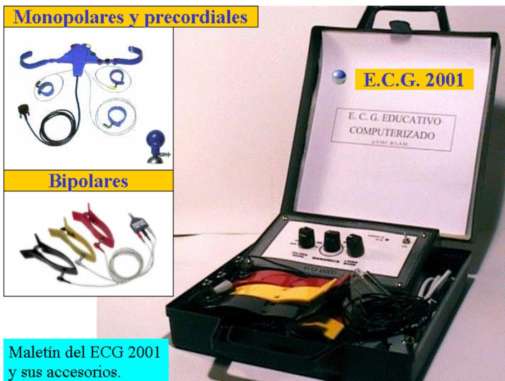
**Fotografía 1.** Electrocardiógrafo ECG-2001 en su caja.
